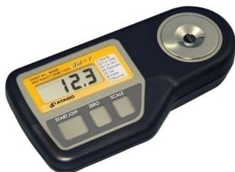
Имеет 7 шкал и разработана для работы в сложных климатических условиях, особенно в местах с высокой влажностью, для быстрого и точного измерения концентрации виноградного сусла.
