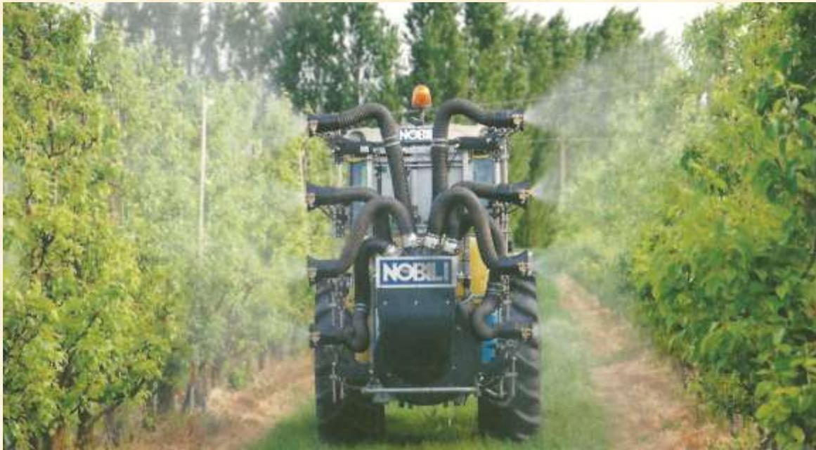
*Опрыскиватель с адаптивной автоматической системой управления воздушным потоком и подачей рабочего раствора на основе данных ультразвуковых датчиков о структуре растений.*
