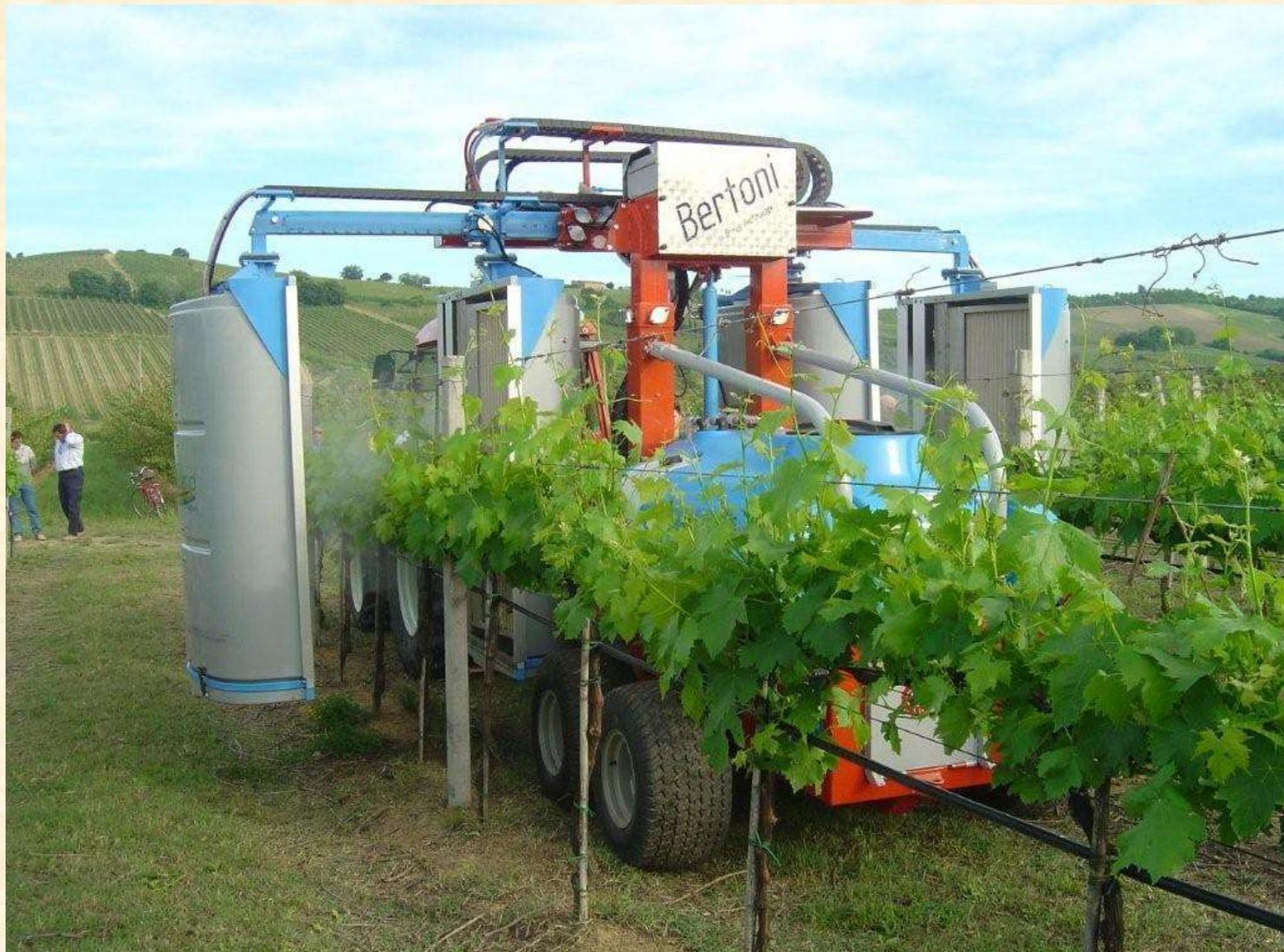
Тоннельный опрыскиватель фирмы «Бертони»
